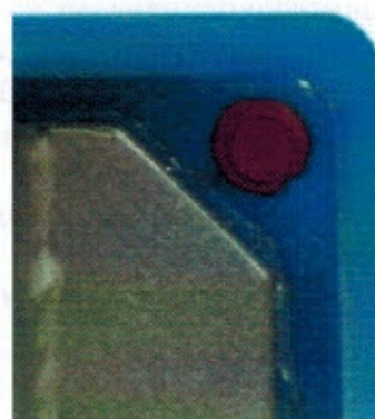
Рисунок 3 - Места пломбирования влагомера MBH-1
