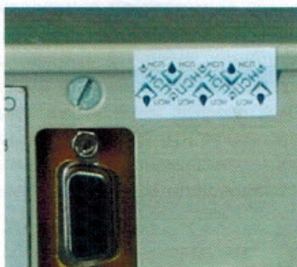
Рисунок 3 - Места пломбирования влагомера MBH-1
